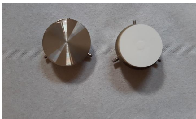
Figure 8 – Modèle de porte-cible utilisé actuellement (avec cible à droite) ; dimensions à préciser pendant la phase de conception
